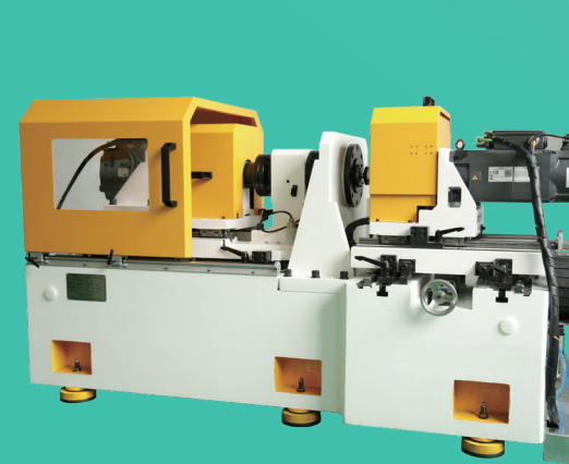
谐波减速器性能测试台
